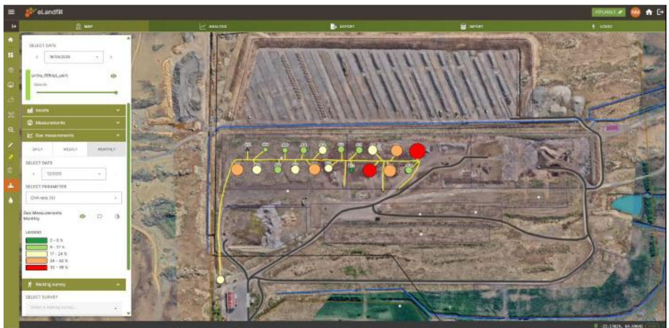
Mynd 5. Yfirlitsmynd ReSource af metangaskerfinu í Fíflholtum. Eins og sjá má á myndinni er gasi safnað úr 20 söfnunarholum og leitt þaðan (gul lögn) að brennara, sem staðsettur er skammt frá þjónustuhúsi urðunarstaðarins.
