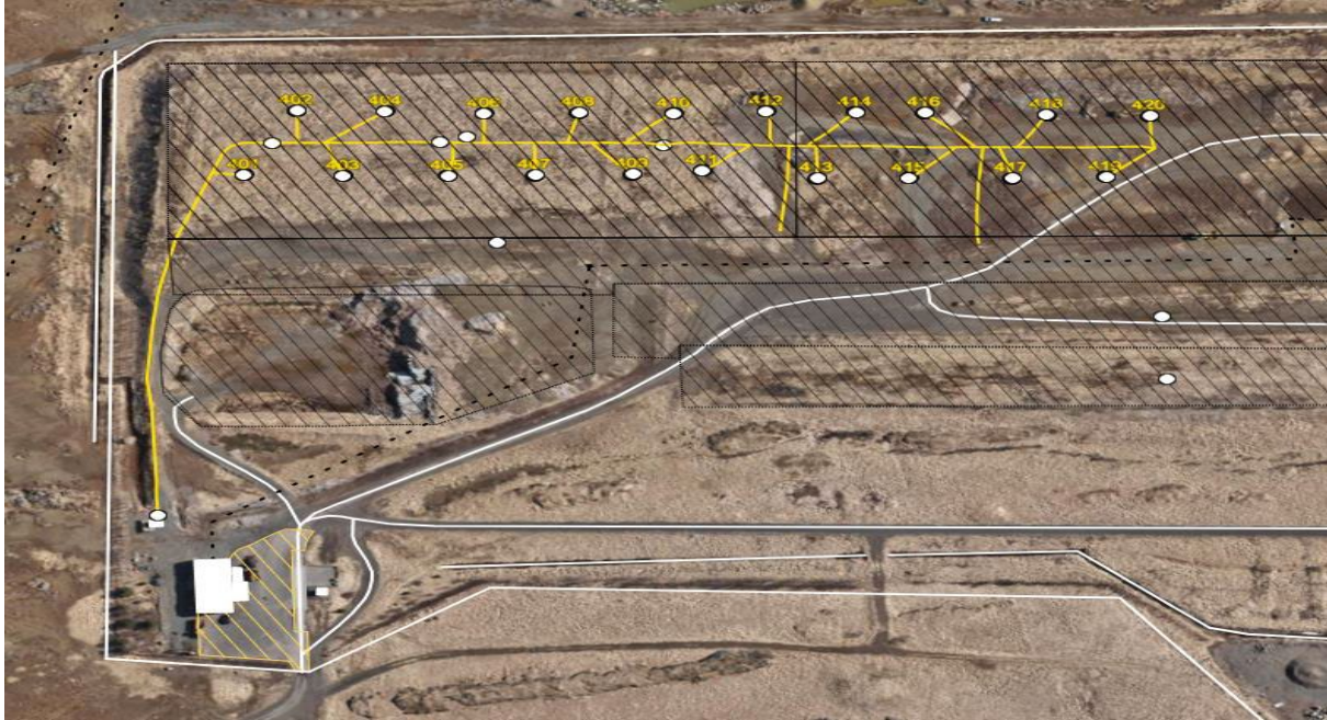
Mynd 3. Teikning af söfnunarholum sem tengjast metangassöfnun í Fíflholtum.
