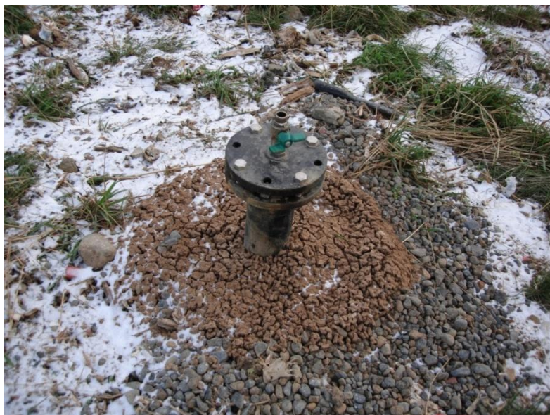
Mynd 6: Stútur á rannsóknarborholu metangasmælinga í Fíflholtum. (Ljósm. HBJ 16.11.09)
