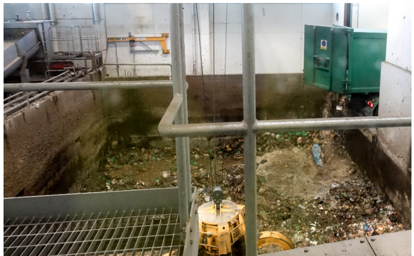
Móttaka og forvinnsla matarleifa og annars lífræns úrgangs. Matarleifar koma að hluta til í plastpokum og þarf að forvinna úrganginn með hökkun og síðan með skrúfupressu.
